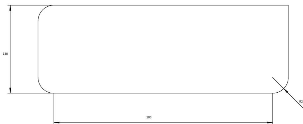
图 2-2-1 机器人运行轨迹平面尺寸图
