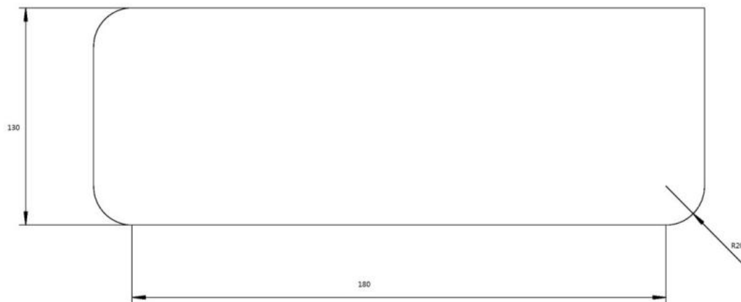
图 2-2-9 机器人运行轨迹平面尺寸
